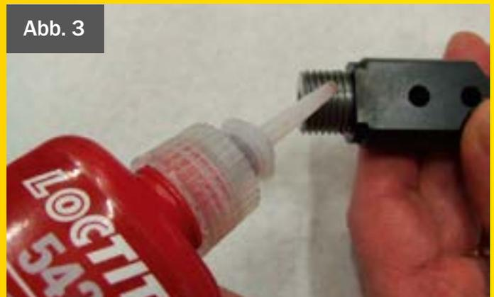
Zur Sicherung gegen Lösen ist Loctite 542 zu verwenden (siehe Abb. 3 & 4).
