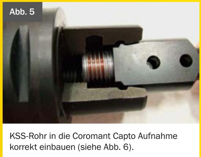
KSS-Rohr in die Coromant Capto Aufnahme korrekt einbauen (siehe Abb. 6).
