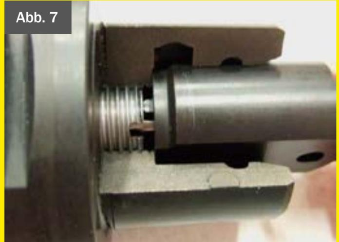
Bei Durchdrehen der Montagevorrichtung ist die Endposition des KSS-Rohres erreicht.
