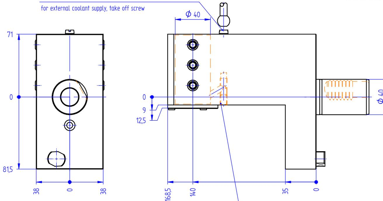
bei interner Kühlmittelzufuhr Gewindestift herausdrehen bis er bündig mit Außenkante ist
