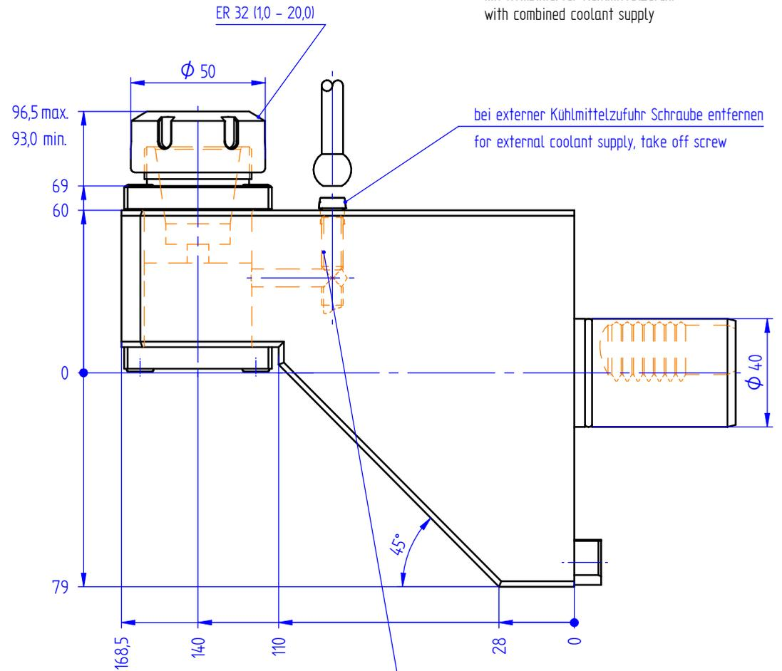
bei interner Kühlmittelzufuhr Gewindestift herausdrehen bis er bündig mit Außenkante ist
